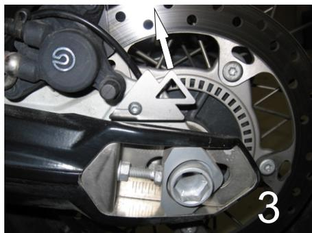
4.) Ziehen Sie die Schraube mit einem max. Drehmoment von 9,7Nm an.
