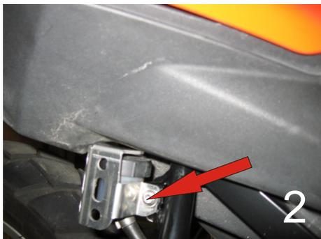
2) Fixieren Sie den Bremsflüssigkeitsbehälter und die Bremsflüssigkeitsbehälter Abdeckung so dass Sie diese mit der Linsenflanschkopfschraube befestigen können.
