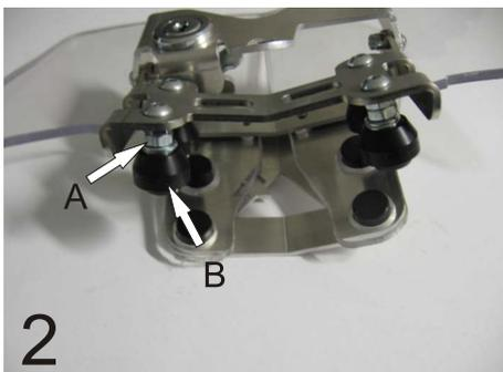
3.) Setzen Sie den Spoiler vorsichtig von oben auf das Windschild. Wenn die gewünschte Stellung erreicht ist, schließen Sie den Verschluss und stellen an den Einstellmutter die Stärke des Windschildes ein. Die Einstellmutter werden mit etwas Kraft auf das Windschild gedreht. Wenn der Spoiler fest auf dem Windschild sitzt, werden die Kontermutter festgezogen.
