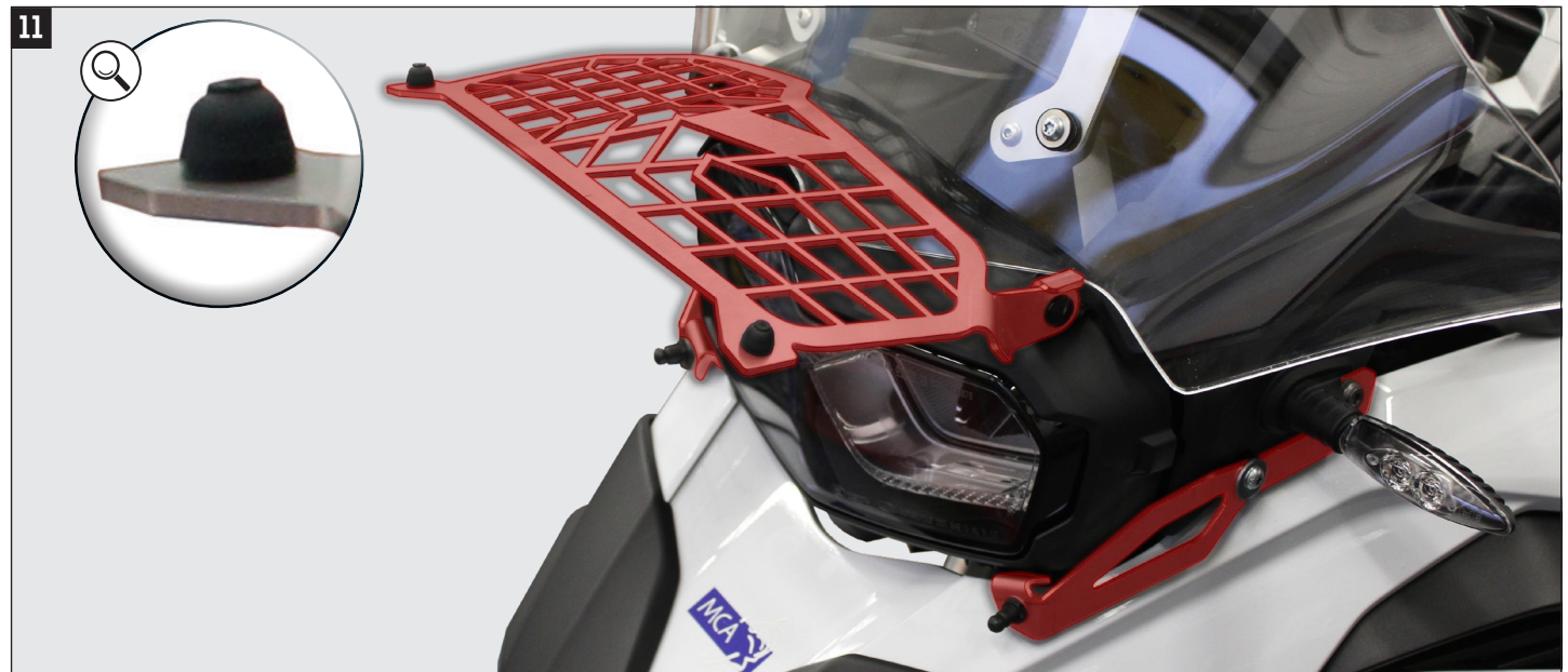
08 Drücken Sie die Verkleidung bei Seite um den Halter montieren zu können. Press the panel aside to mount the bracket.
